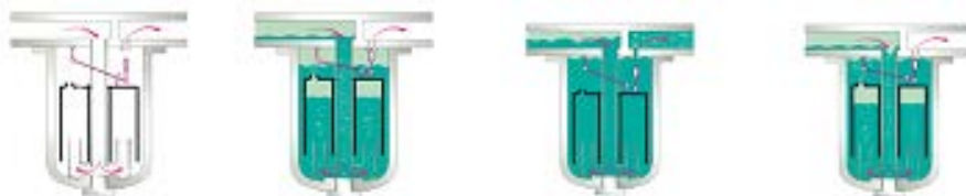
Слика 8.32 Принцип рада одвајача кондензата са звоном
