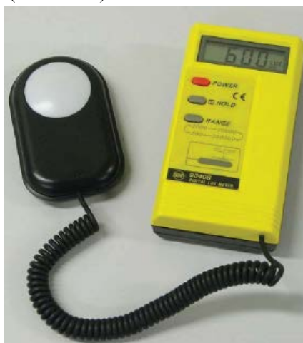
Слика 10.9 Инструмент за мерење нивоа осветљености (луксметар)
