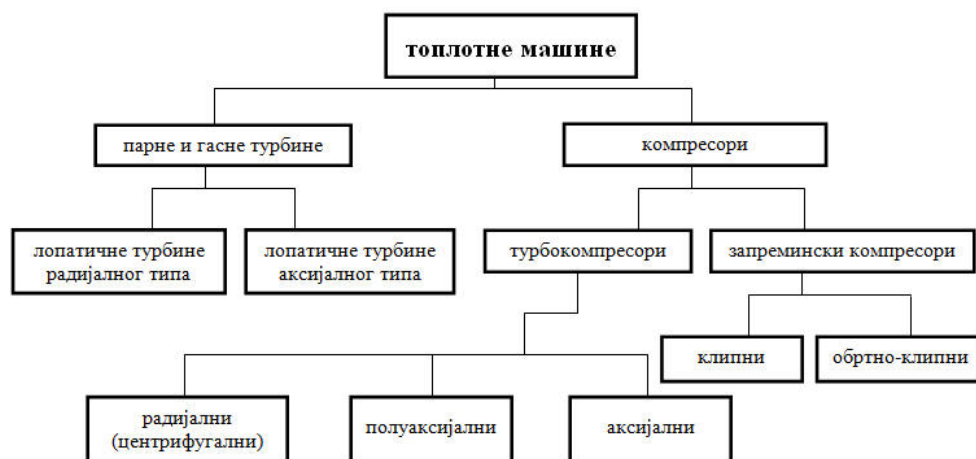
Слика 12.1 Подела топлотних машина [12.2]
