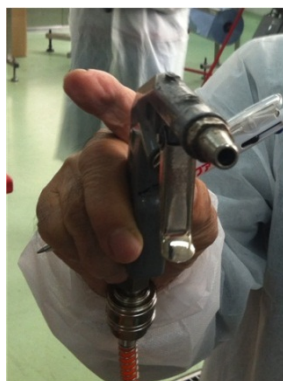
Слика 12.20 Ваздушни пиштољ за компримовани ваздух
