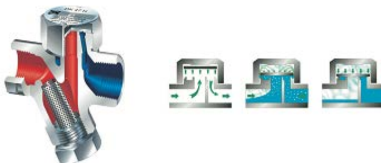
Слика 8.33 Конструкција са фазама рада термостатског одвајача кондензата са биметалом [8.1]
