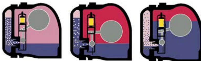
Слика 8.31 Принцип рада одвајача кондензата са пловком и са термоелементом за одзрачивање [8.1]
