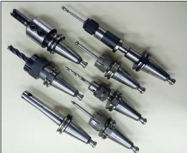
Rezni alati i držači, pripremljeni prema Planu alata
