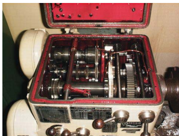
b) Univerzalni strug. Primer prenosnika za glavno kretanje.
