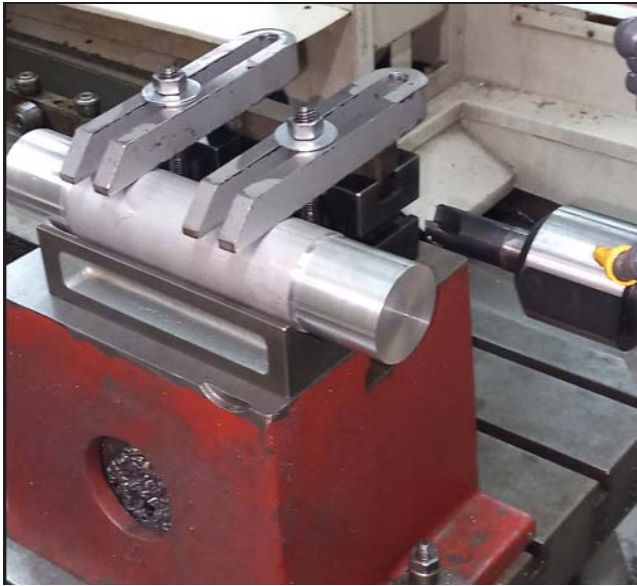
Pripremak baziran i stegnut prema Planu baziranja
