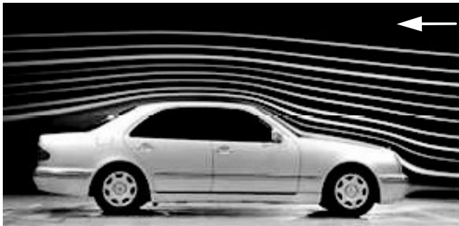
Slika 3.8: Laboratorijska vizualizacija dimom strujanja oko automobila ( http://www.autospeed.com ).
